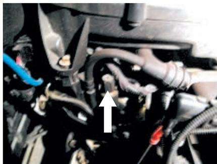
1. Individuare e svitare il tappo di protezione dell'attacco rapido di ispezione della pressione alimentazione benzina.
